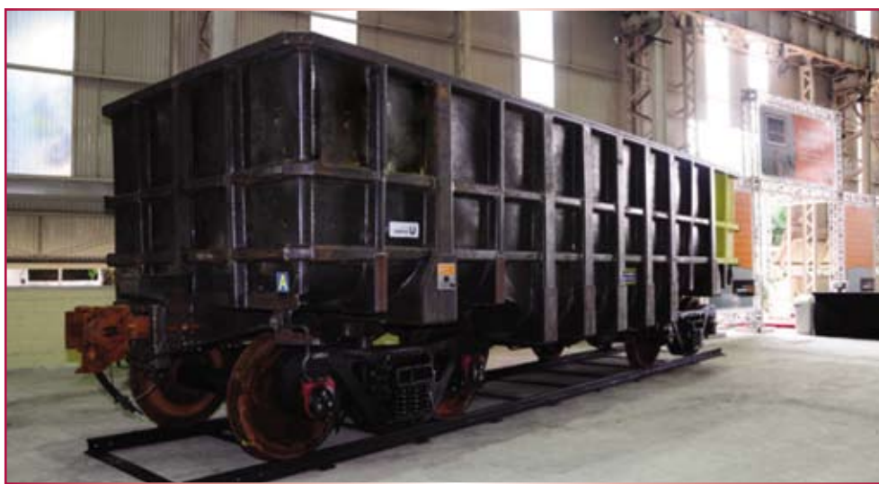
Fig. 1 – Vagão do tipo GDU, um dos modelos atualmente fabricados pela Usiminas Mecânica (12)
